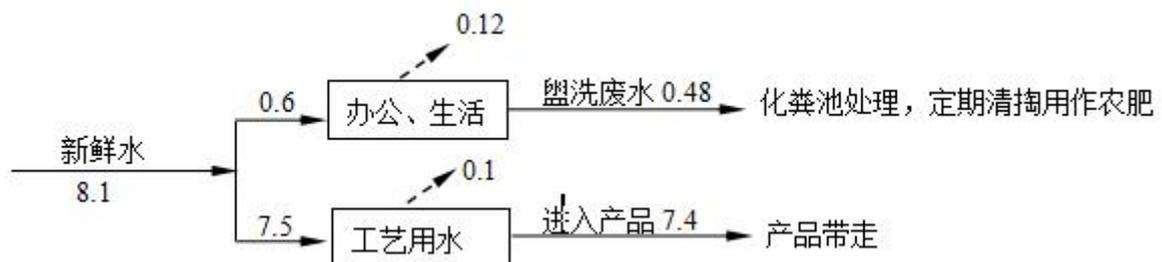
图 6 本项目给排水平衡图(单位: m<sup>3</sup>/d)
