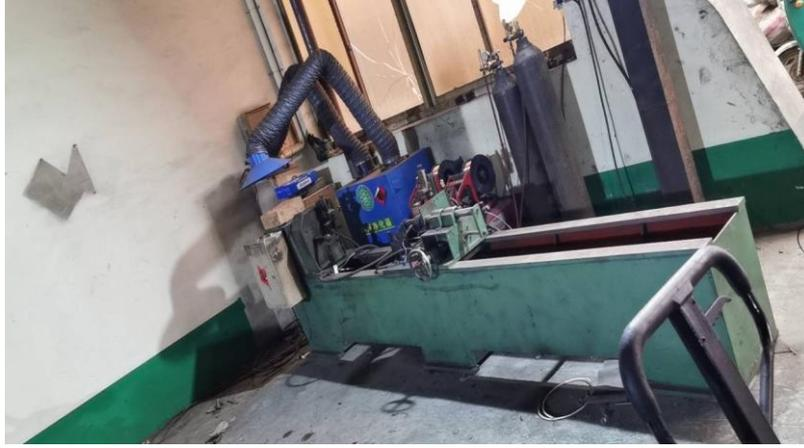
托辊车间焊接工序焊烟净化器
