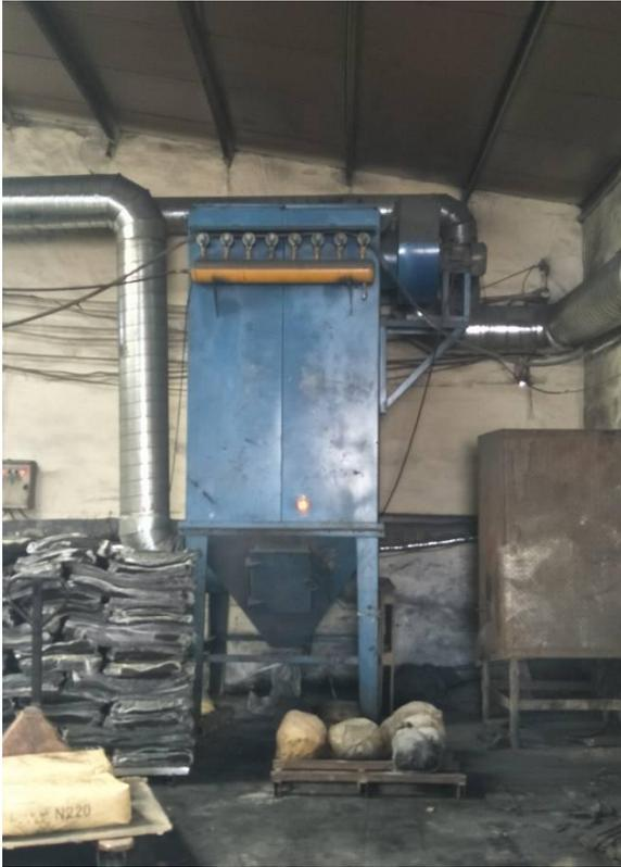
开炼机、挤出机、压延机布袋除尘器
